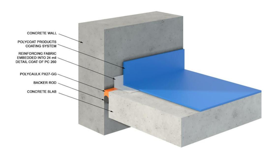
11- JOINT AT WALL/SLAB
